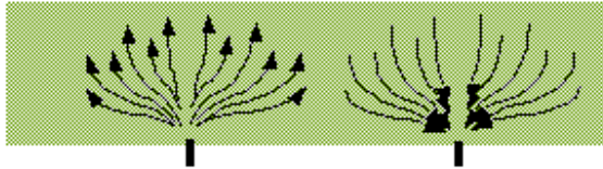
Bild 1: Problematik der lokalen Kräfteinleitung in einen Werkstoff mit geringer Festigkeit.
