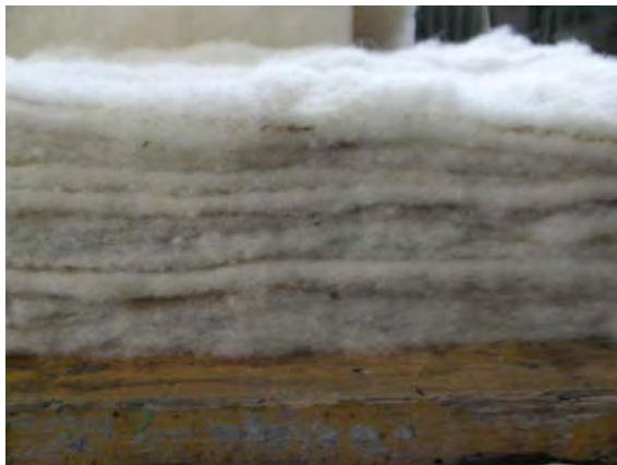
Abbildung 44 Versuchsdämmstoffplatte in Seitenansicht (Mottenmischung zwischen den Filzlagen zu sehen)
