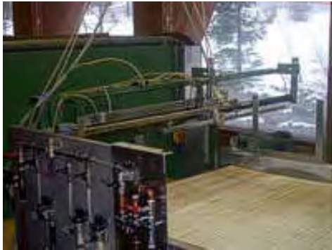
Abbildung 14 Applikationstechnik für die Ausrüstung der gewaschenen Schafwolle mit MITIN FF
