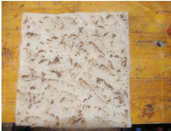
Abbildung 43 Filzschicht mit applizierter Mottenmischung
