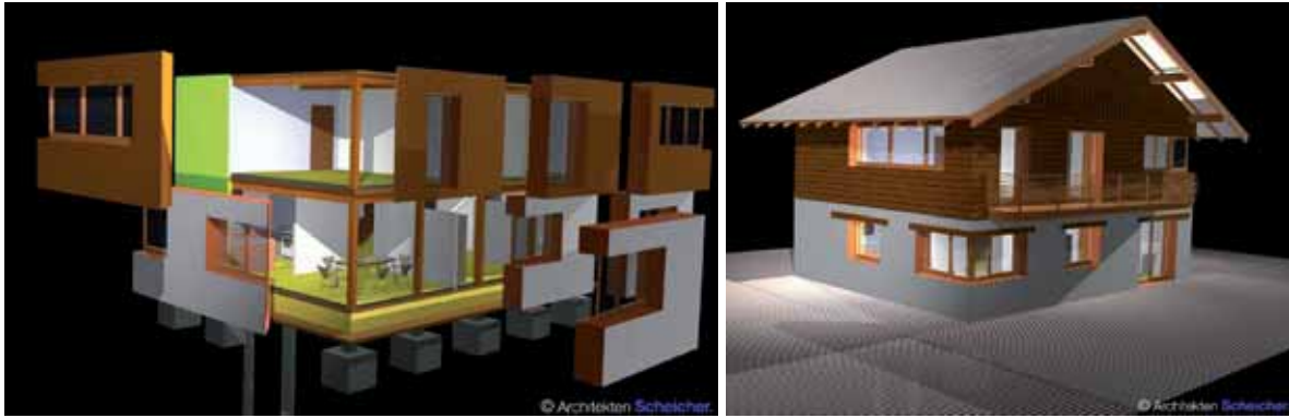
Abbildung 42: Gebäudetyp 3 – „Landhaus-Typ“, Explosionsdarstellung und Ansicht.
