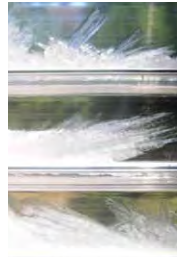
GlassXcrystal: Wärmespeichermodule auf Basis von Salzhydratkristallen im Phasenwechsel, GLASSXcomfort flüssig. Fotos: GlassX AG
