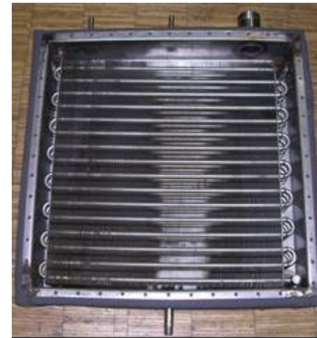
PCM Speicher mit eingehängten Wärmetauscher
