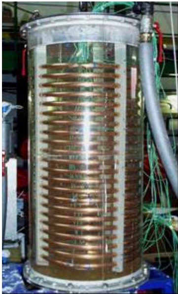
Speicher für mikroverkapselte PCM emulsion
