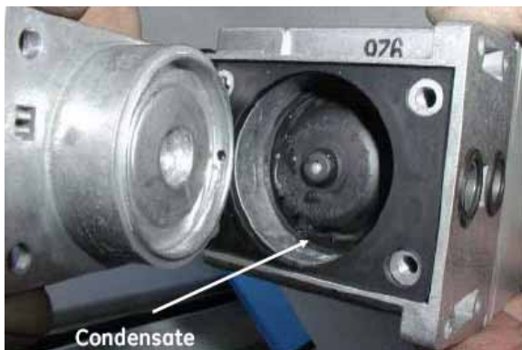
Bild 5: Kondensatanfall im Gasregelventil
