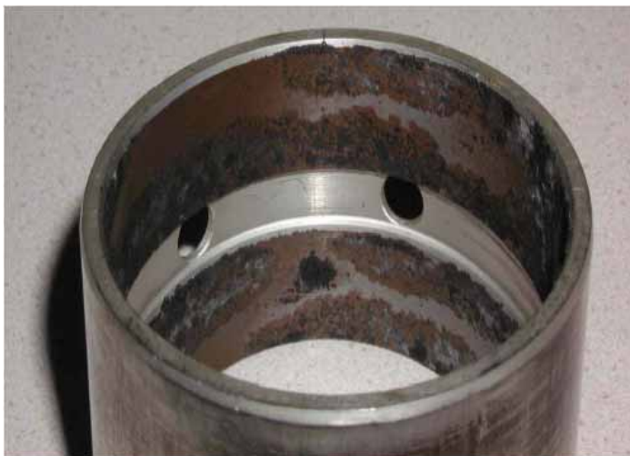
Bild 9: Pleuelbüchse eines ständig im „sauren Bereich“ des Öles arbeitenden Biogasmotors
