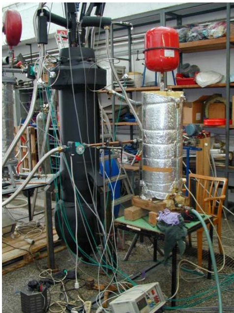
Abbildung 1: Prototyp der Absorptionskälteanlage mit 500 W Kühlleistung am Österreichischen Forschungs- und Prüfzentrum Arsenal
